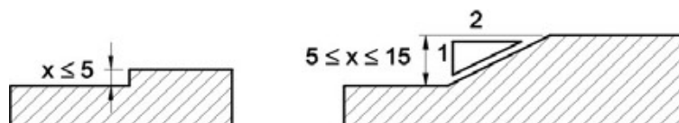
Tratamento de desníveis - Exemplo NBR9050:2004
