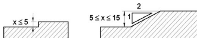
Tratamento de desníveis - Exemplo NBR9050:2004
