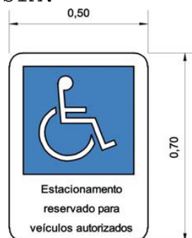
Sinalização Vertical de Vagas em Espaço Interno Exemplo NBR9050:2004
