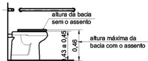
Altura de Bacias Sanitárias - Exemplo NBR9050:2004
