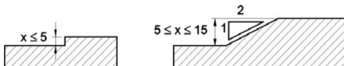
Tratamento de desníveis - Exemplo NBR9050:2004
