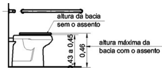
Altura de Bacias Sanitárias - Exemplo NBR9050:2004
