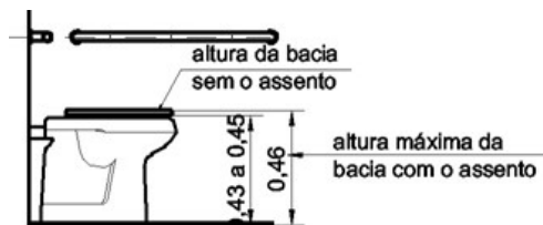
Altura de Bacias Sanitárias - Exemplo NBR9050:2004
