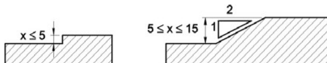
Tratamento de desníveis - Exemplo NBR9050:2004
