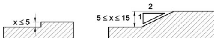
Tratamento de desníveis - Exemplo NBR9050:2004
