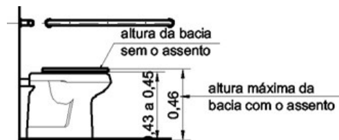
Altura de Bacias Sanitárias - Exemplo NBR9050:2004
