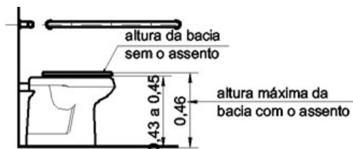
Altura de Bacias Sanitárias - Exemplo NBR9050:2004
