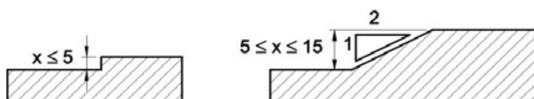
Tratamento de desníveis - Exemplo NBR9050:2004
