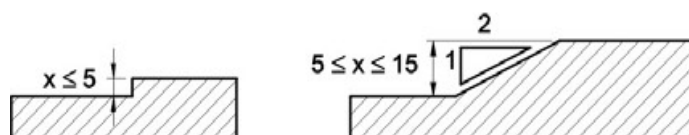
Tratamento de desníveis - Exemplo NBR9050:2004
