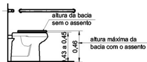
Altura de Bacias Sanitárias - Exemplo NBR9050:2004
