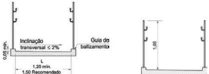
DETALHE DO CORRIMÃO ESC. 1: 25
