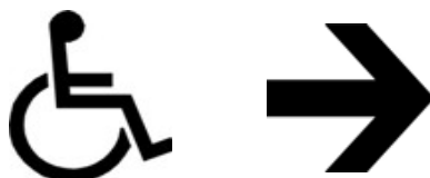
Direcionamento de Acesso para PNE Exemplo NBR9050:2004
