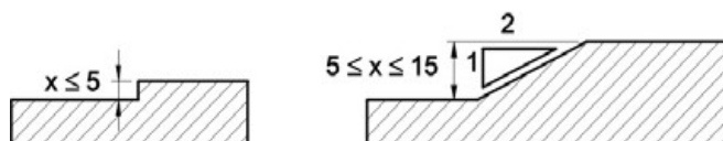
Tratamento de desníveis - Exemplo NBR9050:2004
