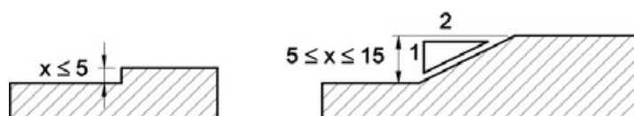
Tratamento de desníveis - Exemplo NBR9050:2004
