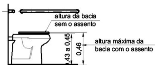
Altura de Bacias Sanitárias - Exemplo NBR9050:2004
