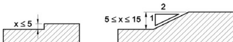
Tratamento de desníveis - Exemplo NBR9050:2004
