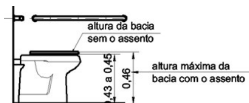
Altura de Bacias Sanitárias - Exemplo NBR9050:2004
