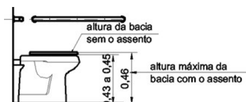
Altura de Bacias Sanitárias - Exemplo NBR9050:2004
