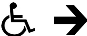
Direcionamento de Acesso para PNE Exemplo NBR9050:2004
