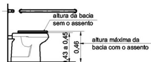
Altura de Bacias Sanitárias - Exemplo NBR9050:2004
