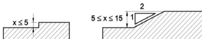
Tratamento de desníveis - Exemplo NBR9050:2004
