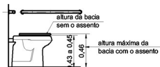
Altura de Bacias Sanitárias - Exemplo NBR9050:2004
