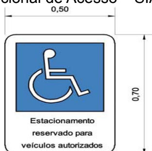
Sinalização Vertical de Vagas em Espaço Interno Exemplo NBR9050:2004
