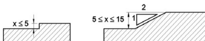
Tratamento de desníveis - Exemplo NBR9050:2004
