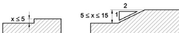
Tratamento de desníveis - Exemplo NBR9050:2004
