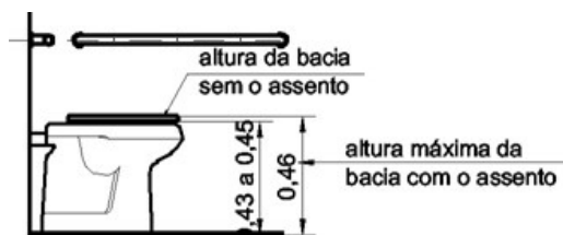
Altura de Bacias Sanitárias - Exemplo NBR9050:2004
