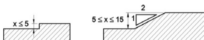
Tratamento de desníveis - Exemplo NBR9050:2004
