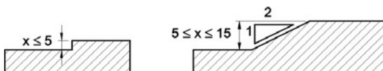
Tratamento de desníveis - Exemplo NBR9050:2004
