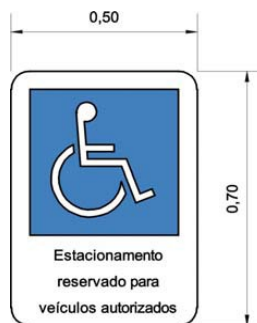
Sinalização Vertical de Vagas em Espaço Interno Exemplo NBR9050:2004
