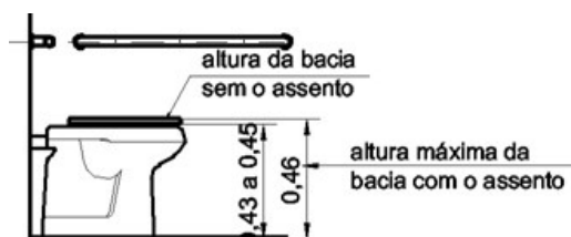
Altura de Bacias Sanitárias - Exemplo NBR9050:2004
