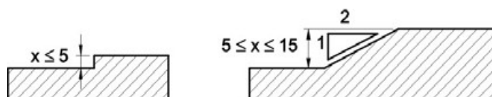
Tratamento de desníveis - Exemplo NBR9050:2004
