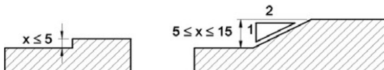
Tratamento de desníveis - Exemplo NBR9050:2004
