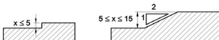
Tratamento de desníveis - Exemplo NBR9050:2004
