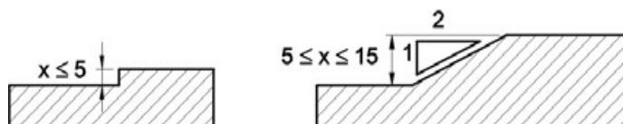
Tratamento de desníveis - Exemplo NBR9050:2004
