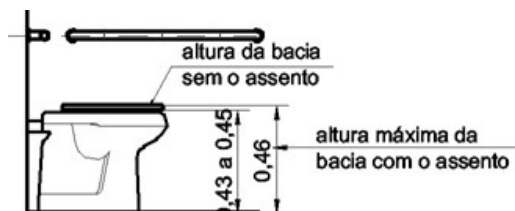
Altura de Bacias Sanitárias - Exemplo NBR9050:2004
