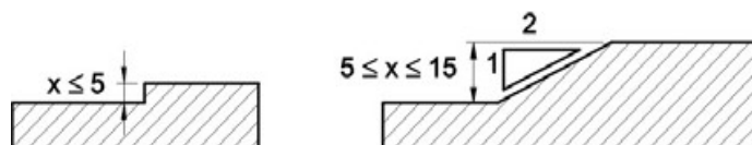
Tratamento de desníveis - Exemplo NBR9050:2004
