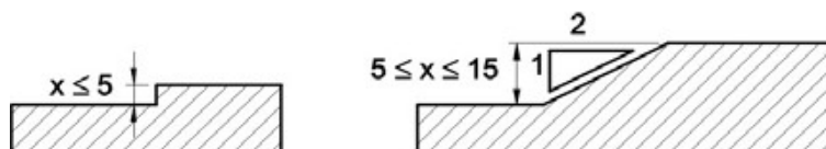
Tratamento de desníveis - Exemplo NBR9050:2004
