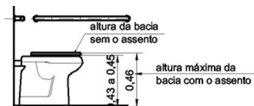
Altura de Bacias Sanitárias - Exemplo NBR9050:2004
