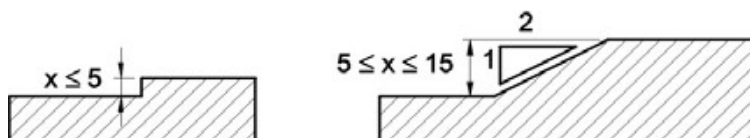
Tratamento de desníveis - Exemplo NBR9050:2004
