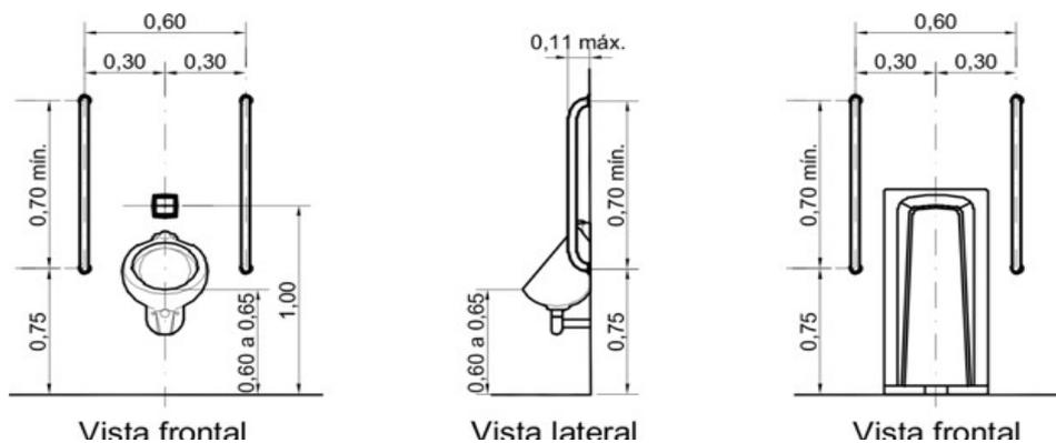
Barras de apoio em Mictórios - Exemplo NBR9050:2004
