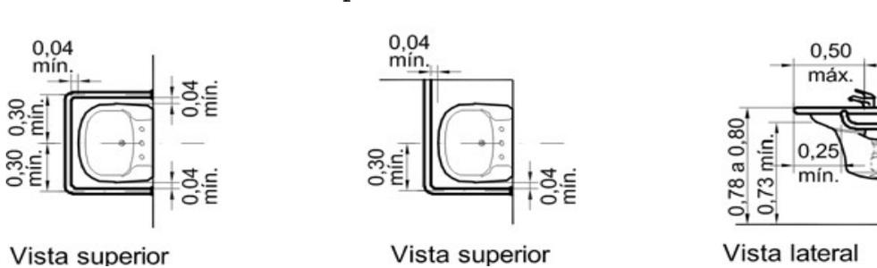
Barras de apoio em Lavatórios - Exemplo NBR9050:2004
